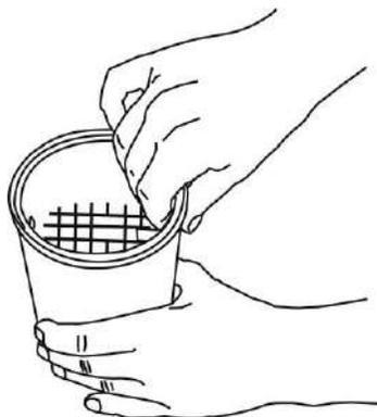
*Способ извлечения вкладыша из корпуса.*
